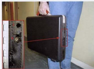
Vue générale de la valise : en détail l'ouverture correspondant au canon (A) et celle du viseur laser (B). Sous ces ouvertures, deux vis servant à la fixation du système.
